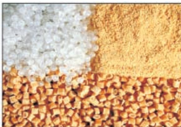
Fig. 7: Composición fotográfica de resina termoplástica, harina de madera y pellets de madera plástica
